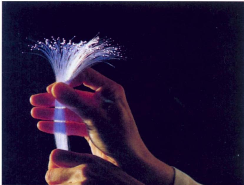
■对于激光等光波段的电磁波，则需要用光导纤维等介质波导来传输；光导纤维是一种透明的玻璃纤维丝，直径只有 $1\sim100\mu\text{m}$ 左右。它是由内芯和外套两层组成，内芯的折射率大于外套的折射率，光由一端进入，在内芯和外套的界面上经多次全反射，从另一端射出。
