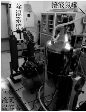
图2 连续进气法测量低温活性炭动力学吸附系数装置实物图(a)和原理图(b)
