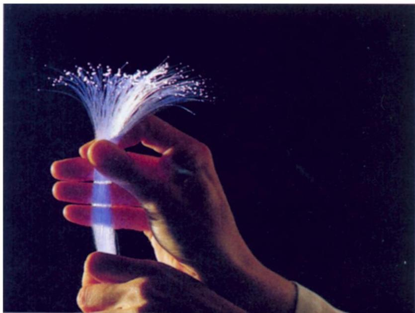
■对于激光等光波段的电磁波，则需要用光导纤维等介质波导来传输；光导纤维是一种透明的玻璃纤维丝，直径只有 $1\sim 100\mu\text{m}$ 左右。它是由内芯和外套两层组成，内芯的折射率大于外套的折射率，光由一端进入，在内芯和外套的界面上经多次全反射，从另一端射出。
